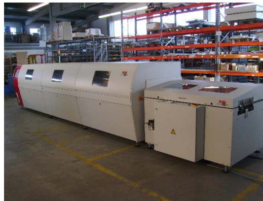
VP 2000-300. Weltweit größte VP INLINE- Lötanlage. Leiterplatten Größe 1500 x 600 mm.
