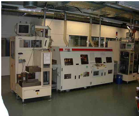
HYDRA. Hybrid Produktionsanlage mit Be- und Entladeroboter
